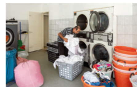
Zubair bij de grote wasmachines. Die produceren zoveel warmte dat de bewoners van de flatwoning die direct boven de wasserij ligt in de winter beduidend minder hoeven te stoken dan hun burens.
